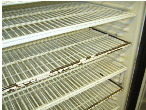
Korrodierte Gitter im Kühlschrank
